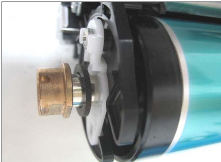
9. Remueva el rodaje de cobre junto con la arandela negra.
