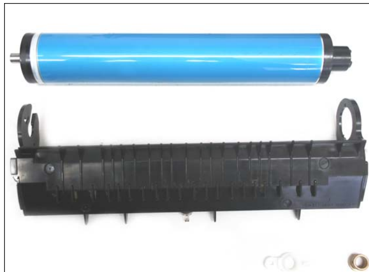
15. Aspire y limpie la unidad del OPC drum. Comenzar el montaje de los componentes en orden inverso.
