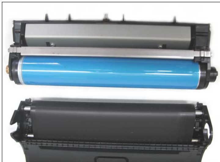
8. El drum separado en sus dos partes.
