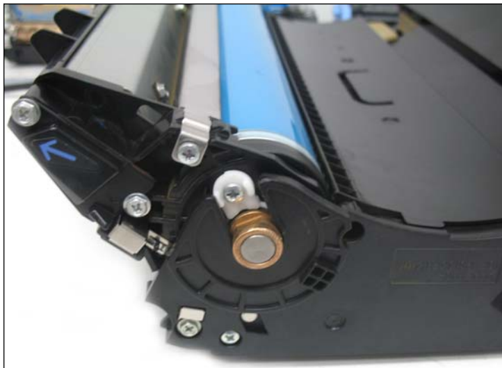
5. Gire la unidad del OPC drum hacia la izquierda.
