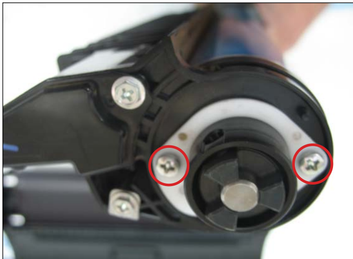
12. Remueva los dos tornillos que estan en el lado opuesto del OPC drum.
