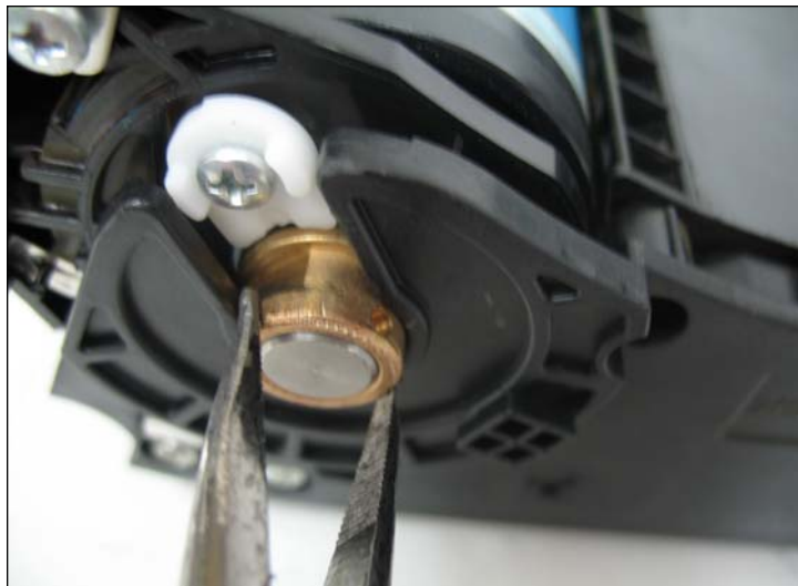
6. Gire el rodaje de cobre hacia la izquierda.
