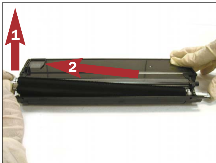
13. La manera más rápida de remover el buje de soporte en el lado opuesto es levantar primero el rodillo magnético. Hálolo cerca de 5 mm después deténgase y posicione el rodillo magnético de nuevo en el cartucho.
