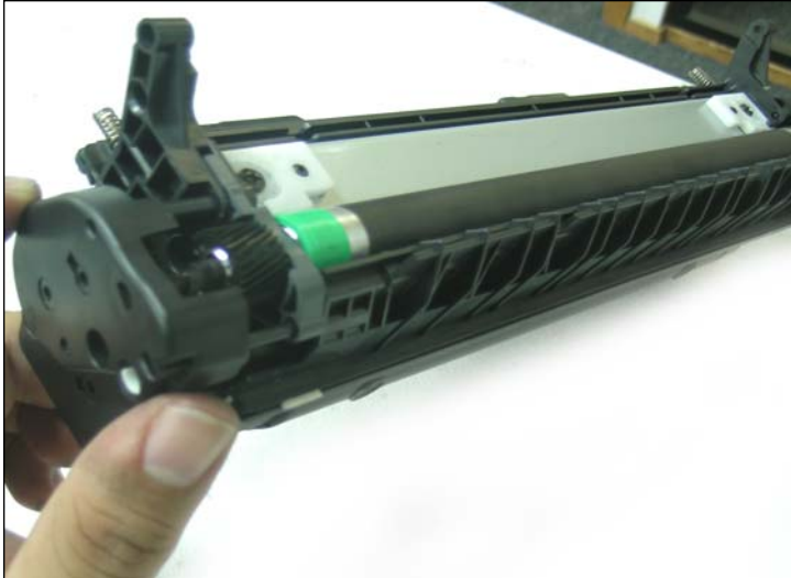
32. Montar la tapa de los engranajes en el otro extremo de la tolva. Fijarla con los dos tornillos
