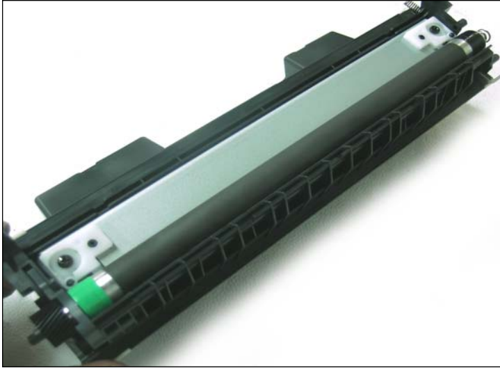
30. Montar el rodillo magnético en la tolva.
