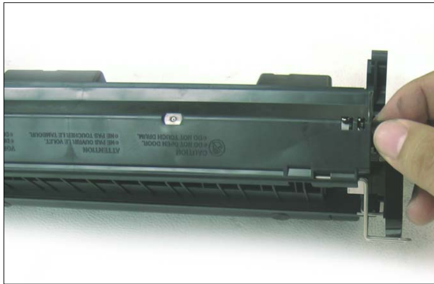
34. Deslizar el brazo de la compuerta en el poste de posicionamiento. Instalar el brazo de la compuerta
