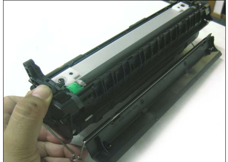
33. Instalar los extremos de la varilla metálica de la compuerta del cilindro en los agujeros de posicionamiento a cada lado de la tolva.
