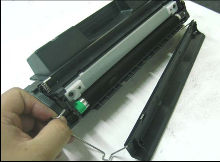
15. Retirar la varilla de la compuerta de ambos lados de la tolva y la compuerta.
