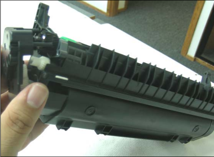
17. Sacar la tapa del tren de engranajes.
