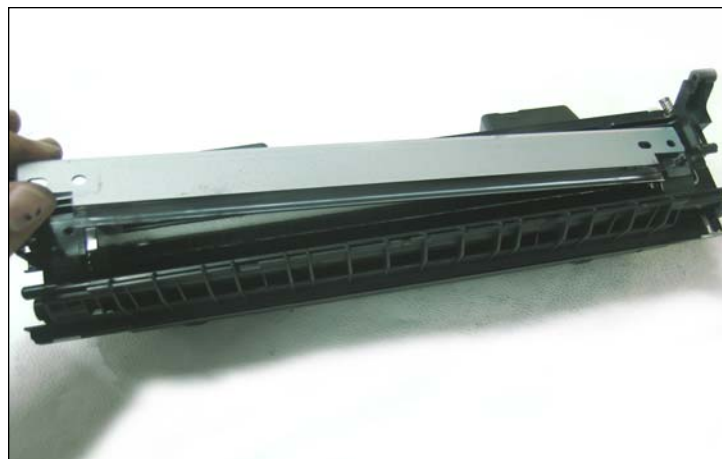
27. Reinstalar la cuchilla de dosificación en la tolva
