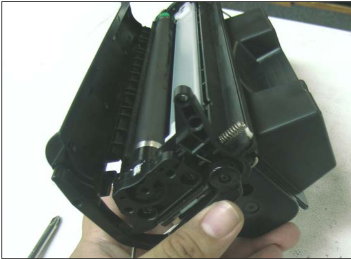
35. Abrir la compuerta para activar el resorte de cierre.
