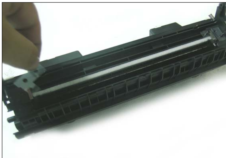
26. Reinstalar los dos espaciadores de Mylar.
