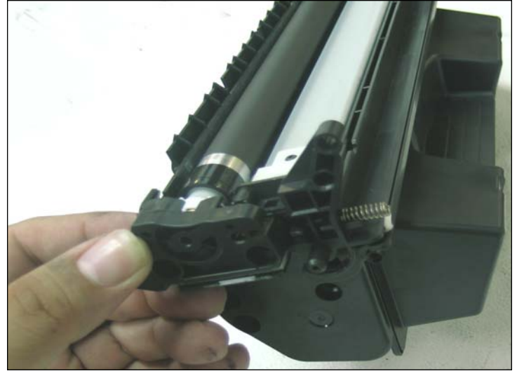
31. Presionar la tapa de contacto del rodillo magnético a la tolva con los dos tornillos en su lugar.
