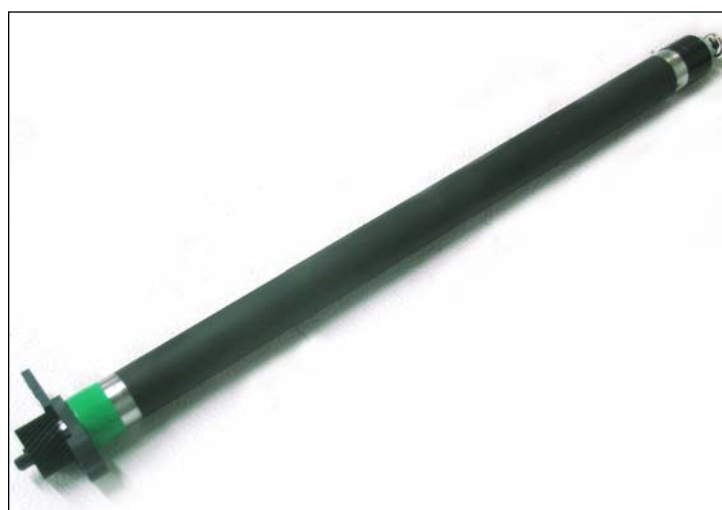
29. Deslizar el buje plástico negro en el extremo de contacto eléctrico del rodillo magnético y el buje verde en el lado opuesto. Instalar el estabilizador con su respectivo buje "C" mirando hacia adentro. Colocar el engranaje de impulsión del rodillo de tal forma que los puntos de inyección del plástico miren hacia afuera.
