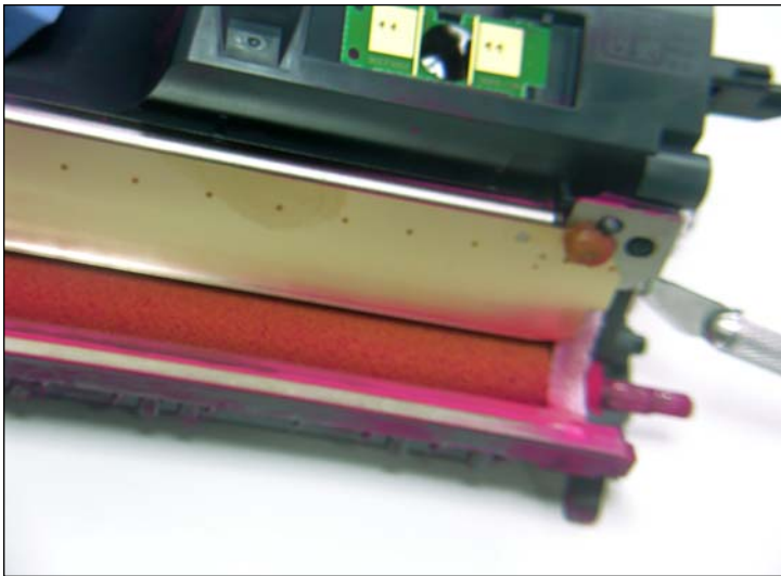
15. Con una hoja de cuchilla fina cortar cuidadosamente el adhesivo detrás de la cuchilla dosificadora que la mantiene pegada a la estructura del cartucho.
