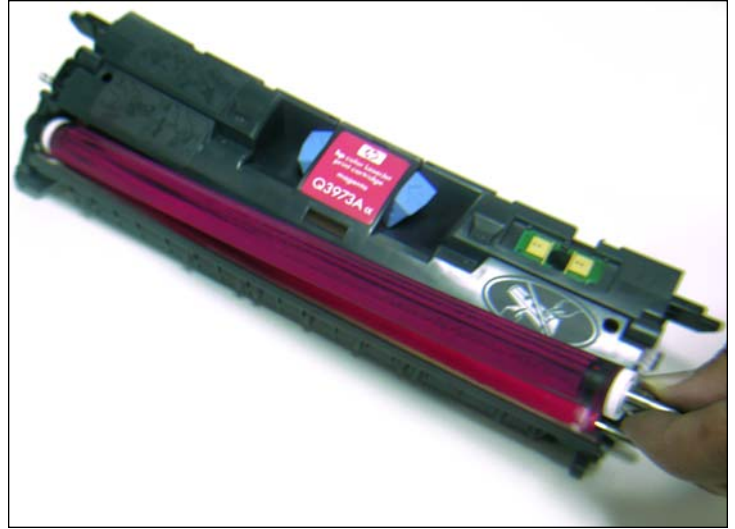
10. Sacar el rodillo de revelación como se muestra.
