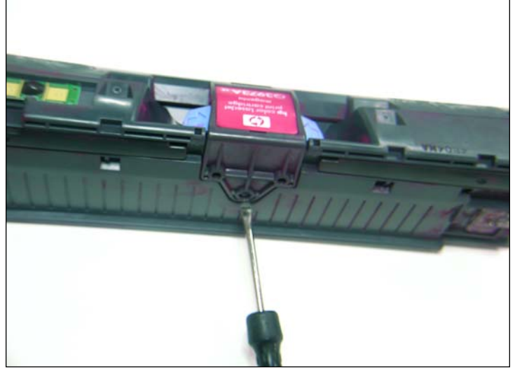
DESMONTAJE DE LA CUCHILLA DE DOSIFICACIÓN 12 Con un desarmador plano pequeño destrabar la tapa de la cuchilla como se muestra.
