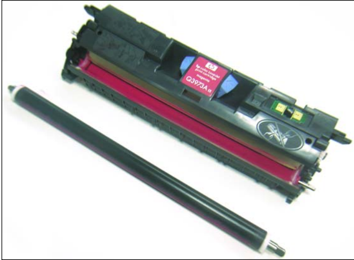
11. No perder los bujes blancos ubicados en cada extremo del rodillo.
