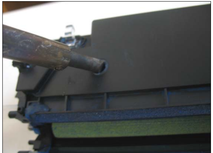
95. Con un soldador , fundir un agujero en la parte superior de la tolva. Este servirá para efectuar el llenado de la tolva con el toner correspondiente.
