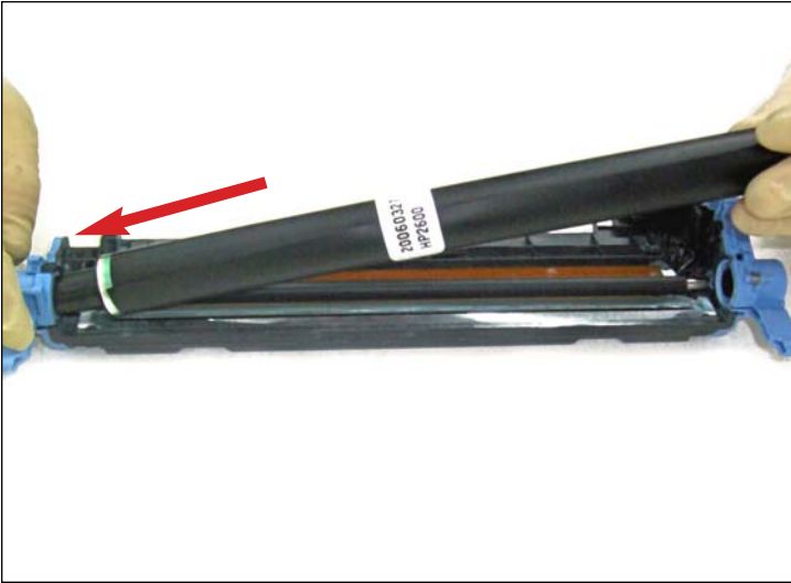
46. Cuidadosamente deslizar el eje fijo del cilindro dentro del soporte opuesto, previamente lubricado, como se muestra.
