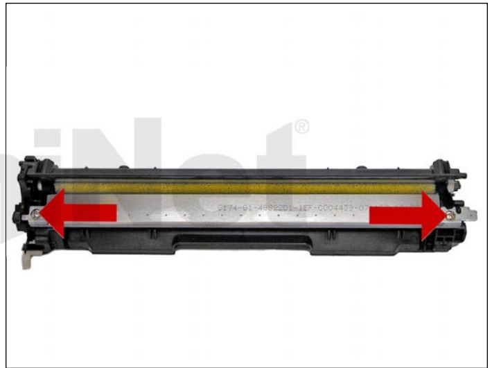
13. Remueva los dos tornillos y la cuchilla dosificadora.
