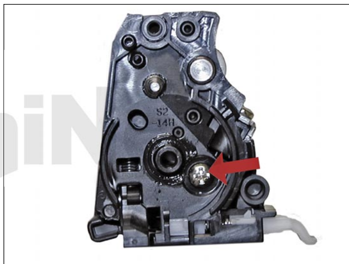
20. Instale la cubierta lateral interior y el tornillo. Hay que ajustar en su sitio esta cubierta lateral. Tenga cuidado, el agujero del tornillo se rompe fácilmente.
