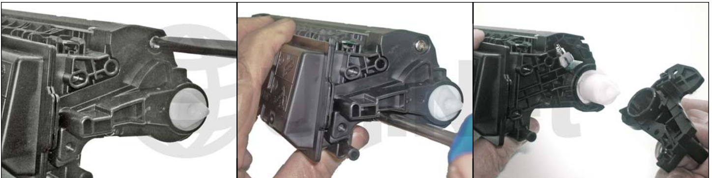
1. Desmontar lateral derecho sacando sus dos tornillos.
