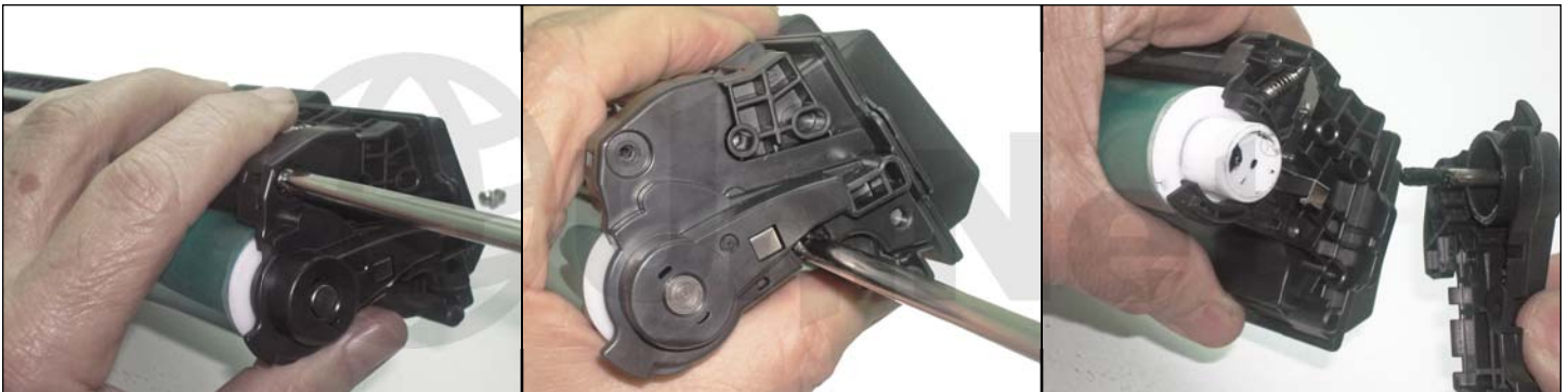
2. Desmontar lateral izquierdo sacando sus dos tornillos.
