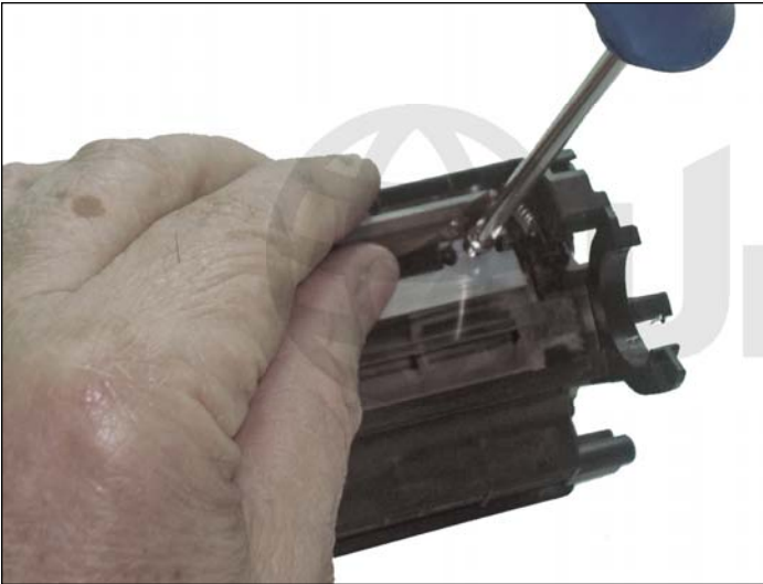
5. Desmontar cuchilla de limpieza sacando los dos tornillos ubicados debajo de la lámina selladora.
