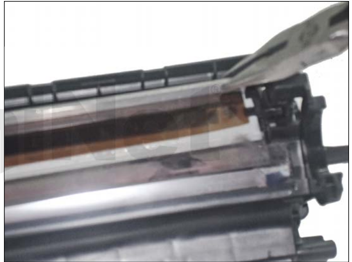
5. Desmontar cuchilla de limpieza sacando los dos tornillos ubicados debajo de la lámina selladora.
