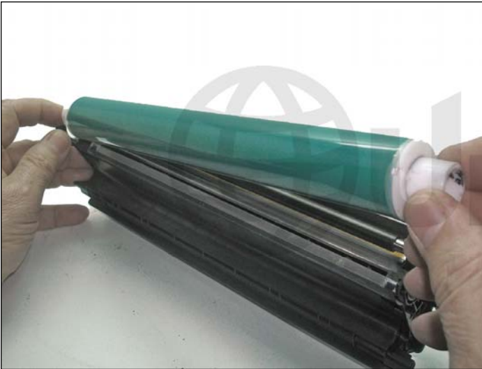
3. Sacar OPC con cuidado y mantener cartucho en vertical para no dejar caer el tóner.
