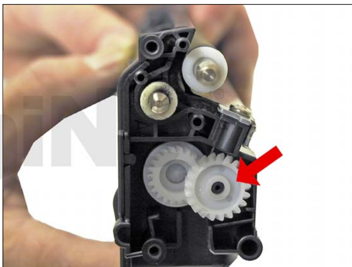
21. Reemplace el engranaje de transmisión como se muestra.
