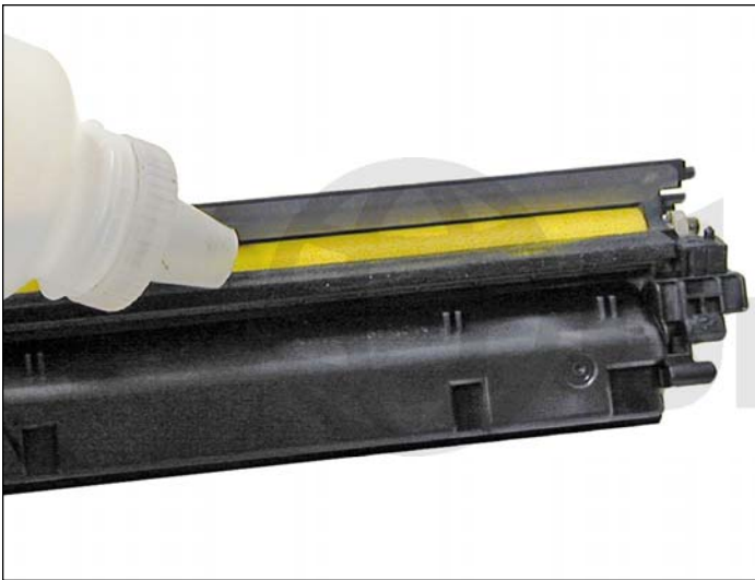
14. En este punto, mientras esta firme, puede limpiar y llenar la cavidad con tóner para uso en HP CP2025.
