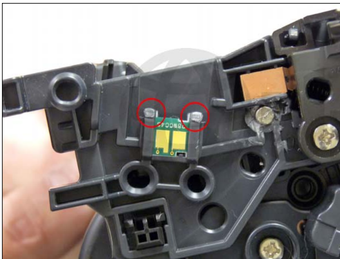
48. Remueva chip cortando los bordes de plástico de ambos lados del mismo.
