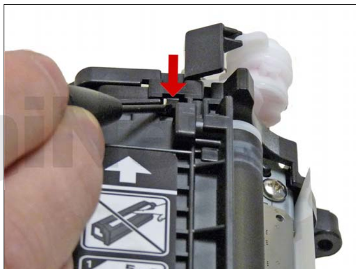
21. Remueva los dos tornillos en el lado de contacto, presione la lengüeta y remueva la cubierta lateral.
