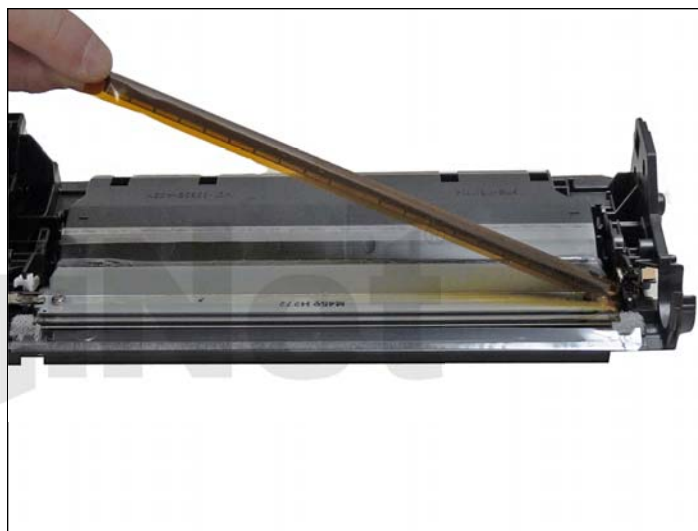
10. Para remover la cuchilla limpiadora, el ensamble de la película ámbar necesita ser removido.
