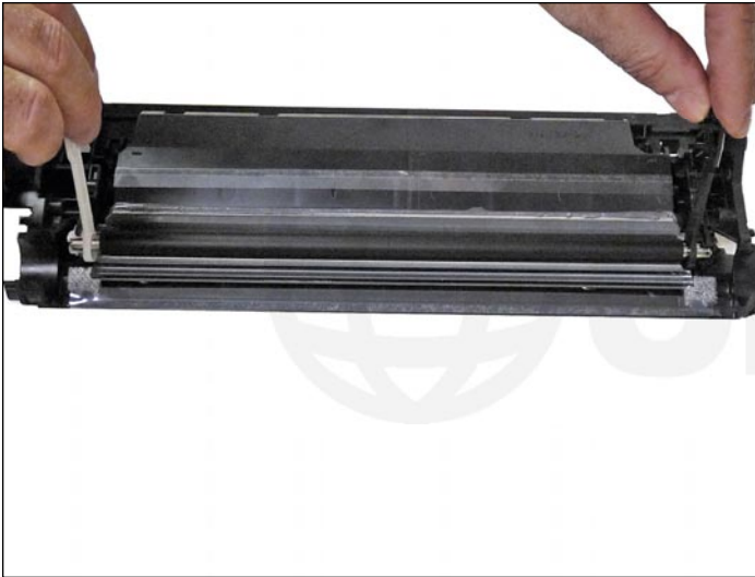
10. Sacar ahora el PCR levantando el conjunto de sus brazos fijadores blanco y negro.
