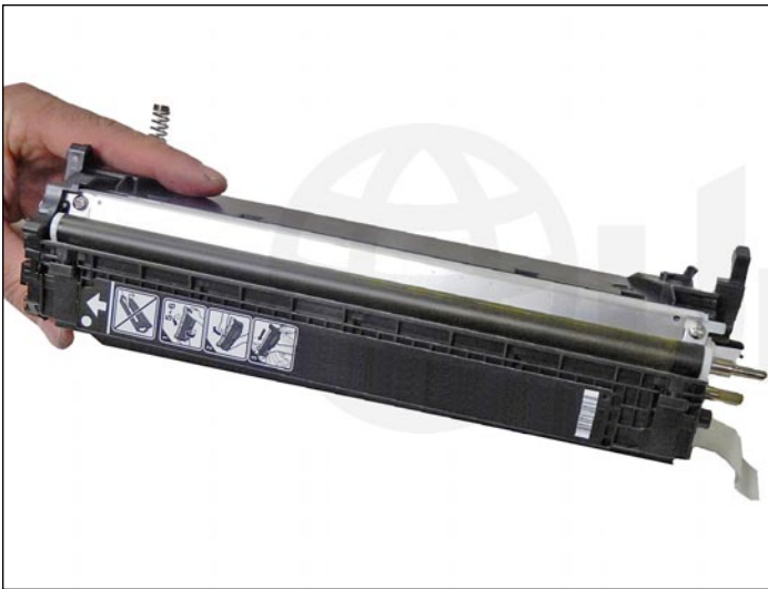
42. Instalar el rodillo revelador correctamente limpio. (NO USAR ningún tipo de producto químico para limpiar el rodillo). Un trapo limpio sin hilachas es lo mejor.
