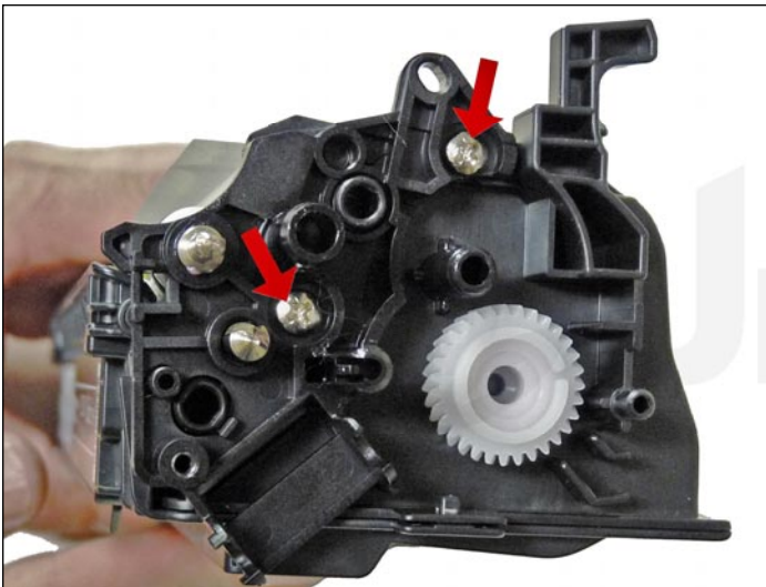
24. Sacar los dos tornillos internos y la placa interna.
