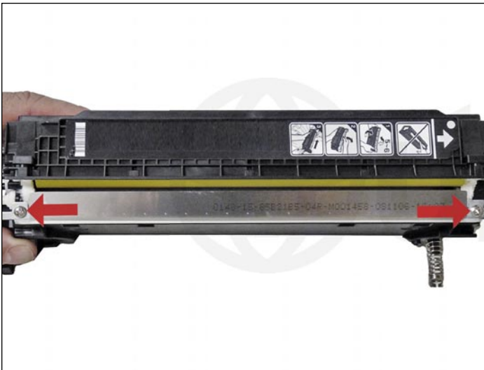
28. Sacar los dos tornillos de la cuchilla dosificadora y levantar la misma de su lugar lo suficiente para poder seccionar el sello que posee con una cuchilla. Sacarla totalmente.
