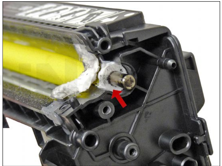
30. Sacar las arandelas de felpa en ambos extremos del rodillo revelador.
