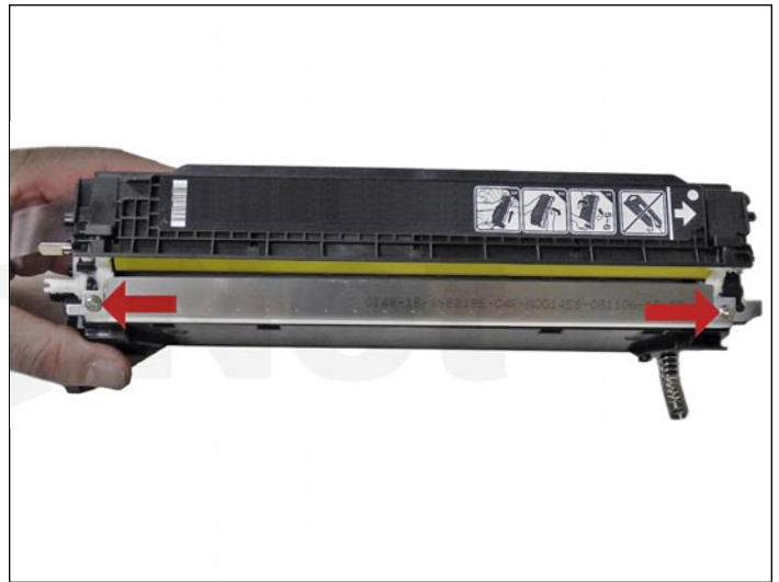
39. Usando los espaciadores adecuados instalar la cuchilla dosificadora y fijar con los dos tornillos.
