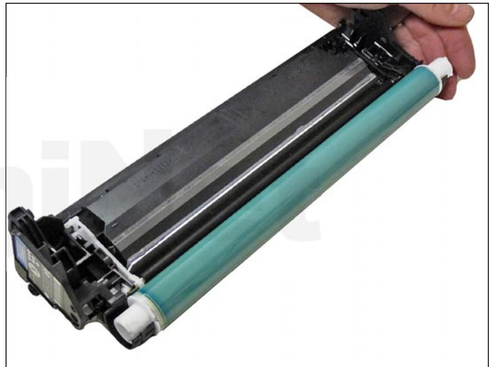
18. Instalar el nuevo OPC. Con el cubo menor hacia al derecha o lado de la etiqueta de la tolva.
