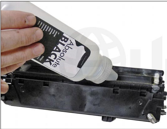
33. Aspirar totalmente la tolva de todo remanente de t nner y cargar con t nner especifico para uso en M551.
