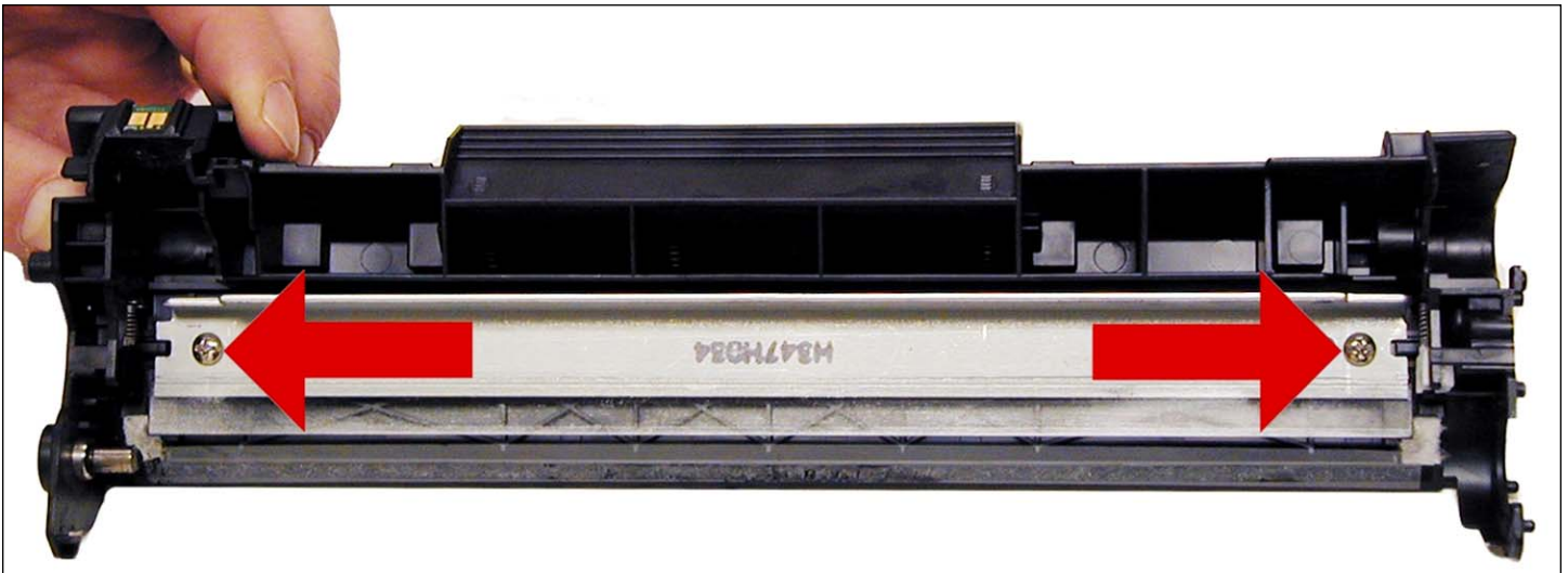
6. Retirar los dos tornillos y la Cuchilla de Limpieza.
