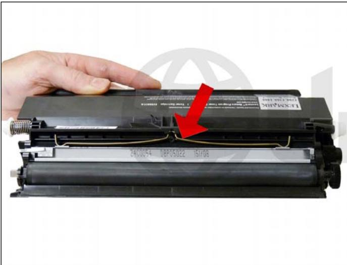
4. Remueva el resorte sujetador. La cuchilla dosificadora se saldrá. Coloque la cuchilla a un lado.
