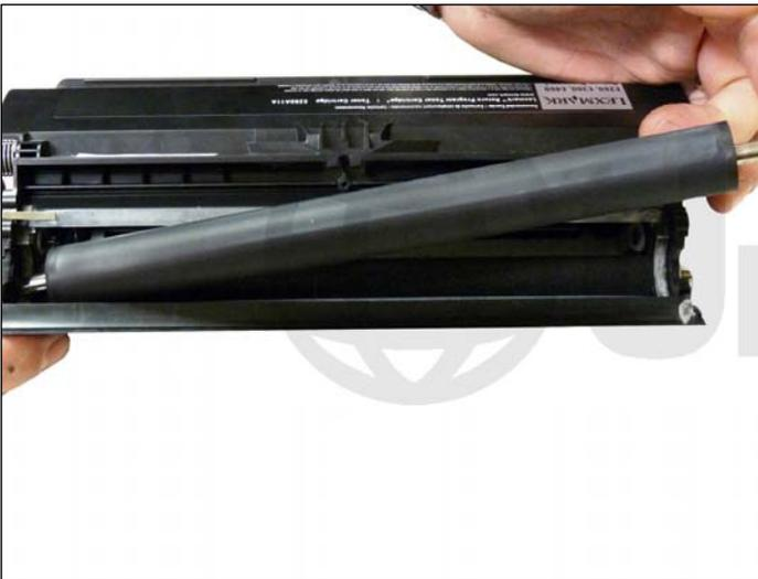
12. Remueva el rodillo revelador. Limpie el rodillo de alimentación de tóner con aire comprimido.
