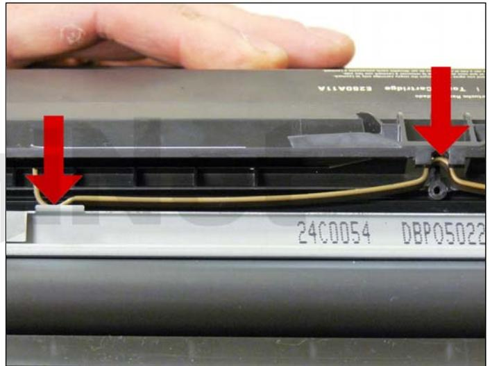
18. Instale la cuchilla dosificadora asegurándose que este posicionada correctamente e instale el resorte sujetador.
