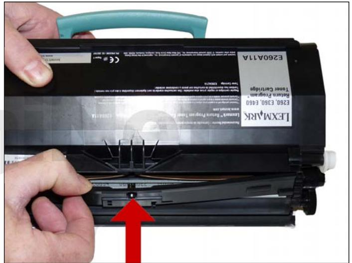
1. Remueva el tornillo del rodillo revelador y la cubierta. Remueva el tornillo y doble ligeramente la cubierta por en medio. Hay dos pines en cada lado de la cubierta que se romperán si solo hala la cubierta y no la dobla un poco para sacarla.
