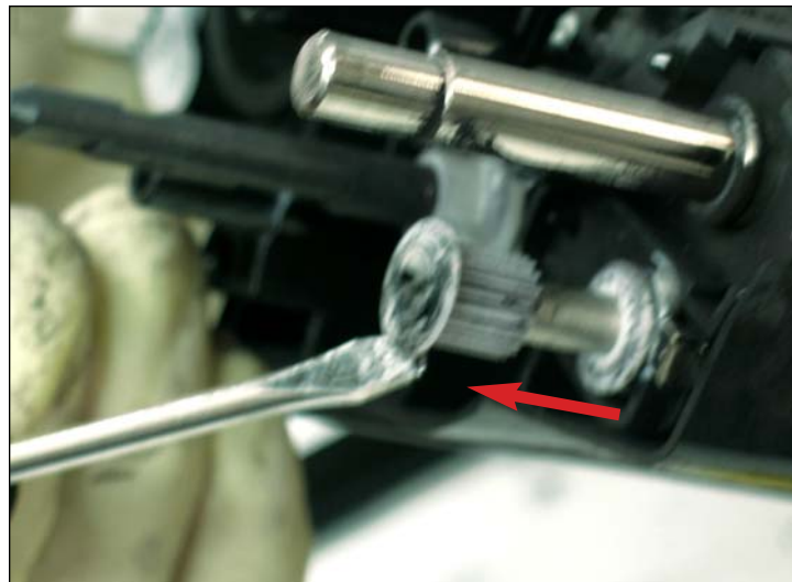
10. Luego deslizar el engranaje hacia afuera.
