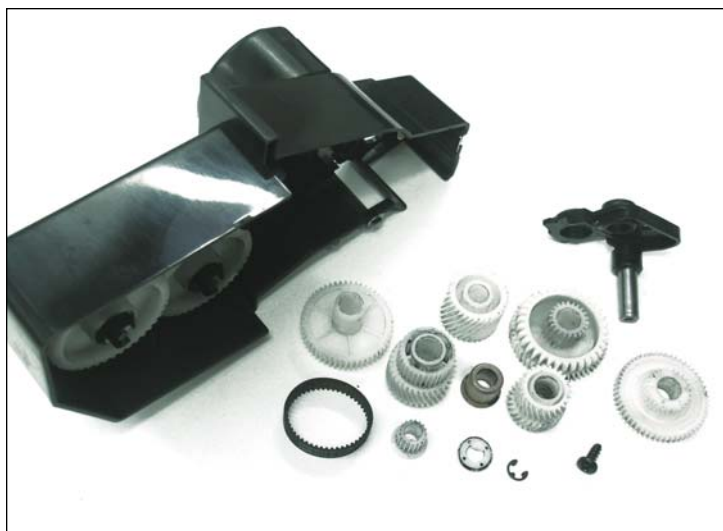
15. Verificar que todos los componentes del lado de los engranajes estén juntos antes de seguir.
