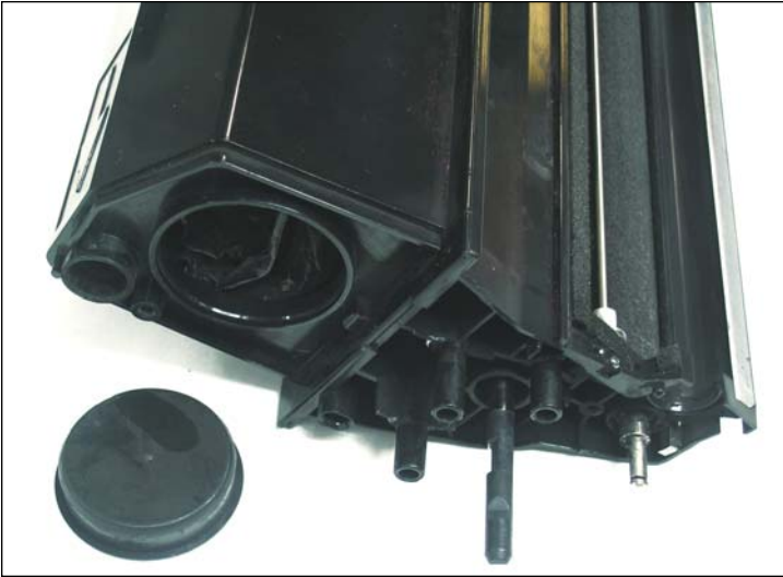
37. Tapon del deposito extraído. Se puede ahora efectuar la limpieza del cartucho.
