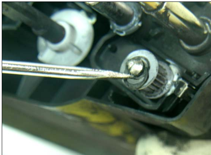
9. Primero sacar el clip "C" que sujeta el engranaje del rodillo de alimentación en su lugar.
