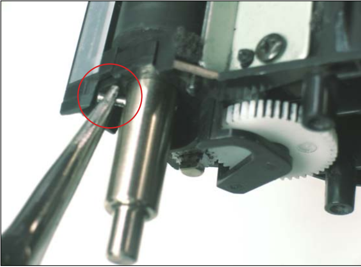
21. Con una pinza de punta fina sacar el perno motriz como se muestra.
