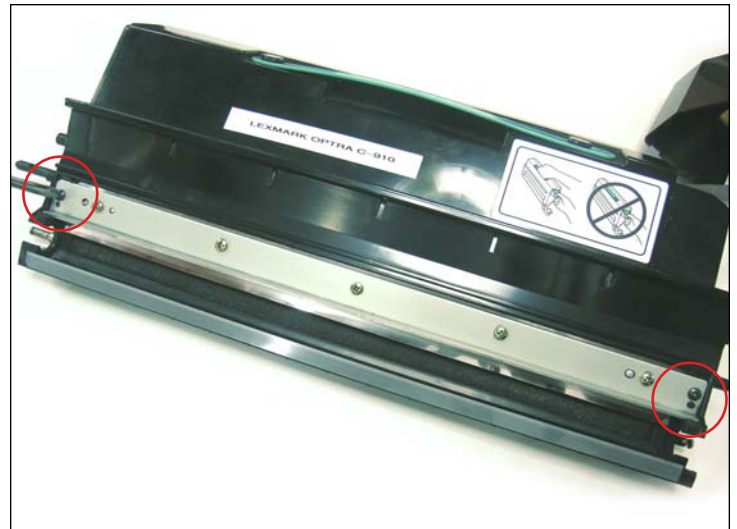
28. Destornillar los dos tornillos que sujetan la cuchilla tal como se muestra.
