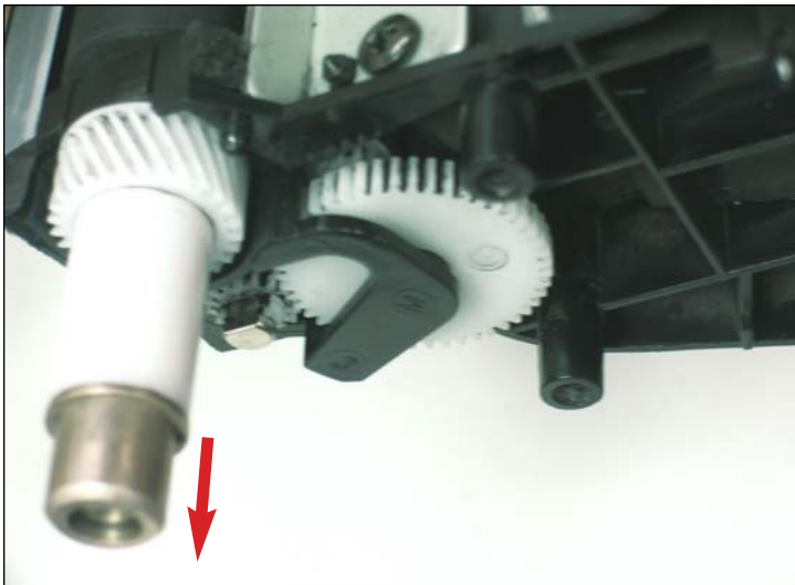
19. Deslizar primero el engranaje y el buje de bronce del eje como se muestra.
