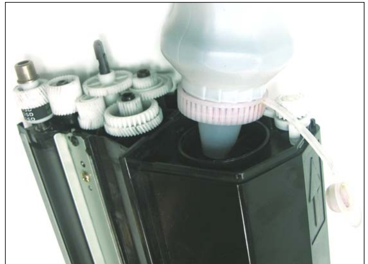
40. Una vez efectuada la limpieza del cartucho, se inicia el montaje del mismo siguiendo los pasos anteriores en forma inversa para finalmente llevar a cabo la recarga del cartucho.
