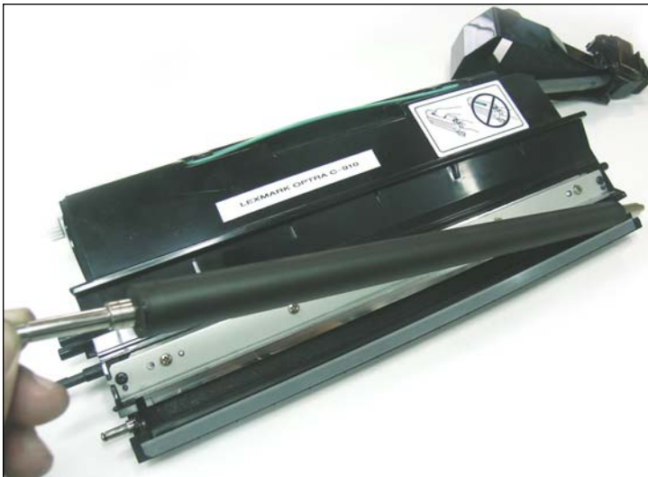
27. Levantar el rodillo de un extremo y luego del otro.
