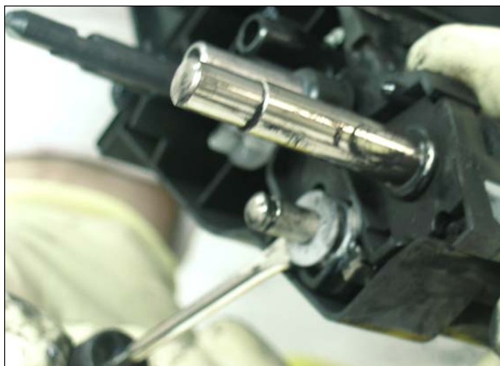
11. Con ayuda de un pequeño desarmador de punta plana sacar la arandela del engranaje como se muestra.
