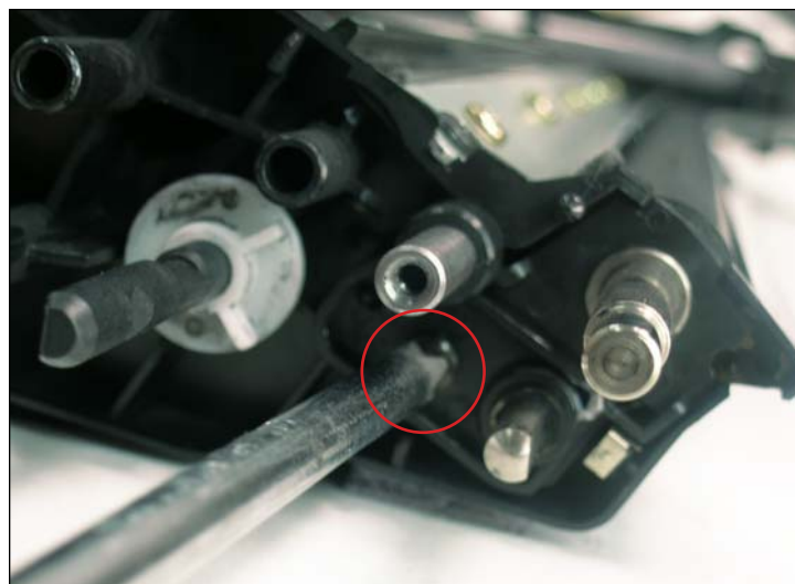
12. Sacar el tornillo que sujeta el soporte en su lugar.
