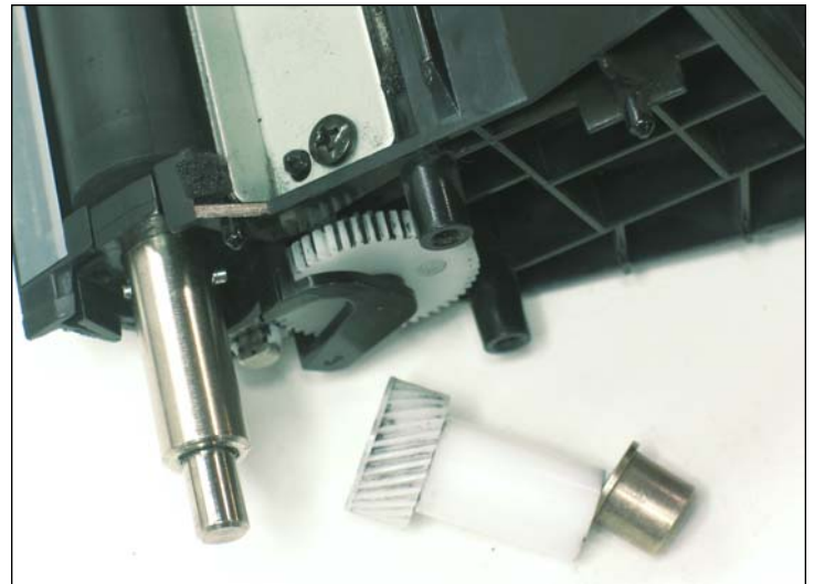
20. Bujes de bronce y engranaje del rodillo revelador extraídos.
