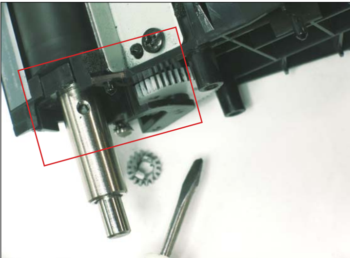
23. Una vez extraído el pequeño engranaje, se puede comenzar a sacar la placa soporte de su posición.
