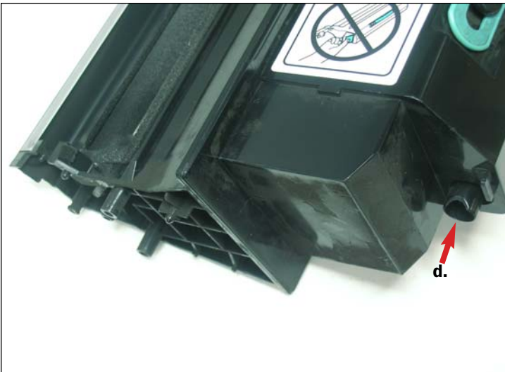
39. Una vez retirado el deposito de toner viejo, se sigue con la limpieza del deposito de toner nuevo y el orificio del rodillo revelador.
