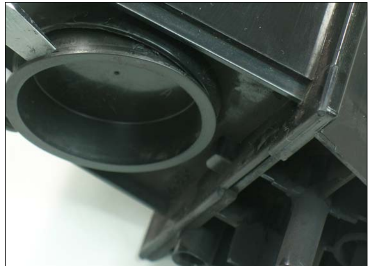
36. Sacar el tapon con un desarmador plano como se muestra.
