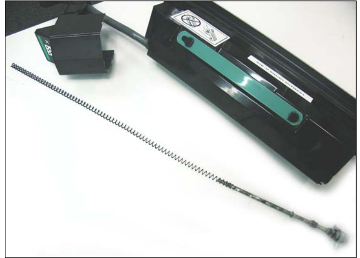
34. NOTA: El engranaje lleva adozado un espiral sinfin que llega desde el deposito de toner usado pasando por el tubo plastico hasta la tapa lateral del lado de los engranajes. El sinfin debe salir completamente al sacar el engranaje.
