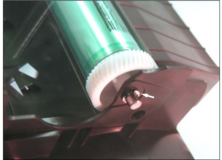
6. Para sacar el cilindro se debe extraer el eje. Primeramente soltar la arandela "E" del eje en el lado del engranaje menor (engranaje con el contacto interno).
