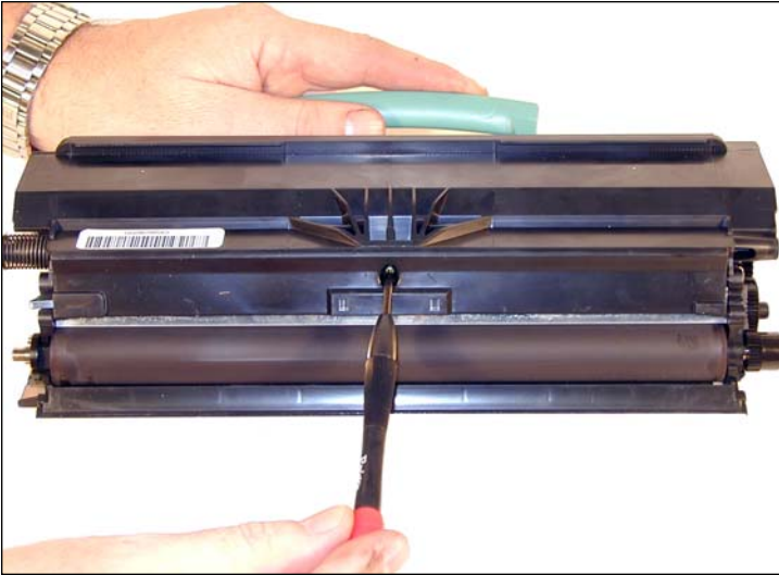
13. Reinstalar la cubierta y el tornillo del rodillo revelador.
