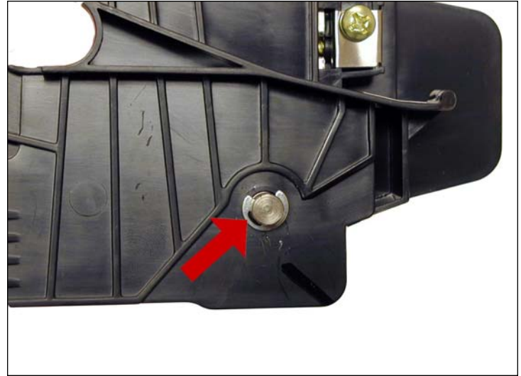
12. Volver a colocar la arandela de seguridad en el extremo del eje.
