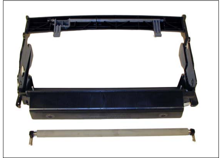
4. Retirar también con cuidado el PCR. Posiblemente los soportes del PCR también salgan al hacerlo y está bien. Hace luego más simple reinstalarlo. Tenga cuidado no tocar la superficie del PCR con su piel pues cualquier signo de grasitud natural puede ser absorbido por el PCR causando luego problemas de impresión. En caso de contaminación se puede limpiar con un paño de algodón levemente humedecido y aplicando en él unas gotas de jabon neutro. Repetir la limpieza con otro paño solamente humedecido.
