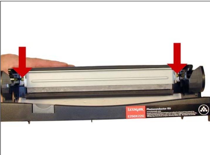
5. Sacar los dos tornillos de la cuchilla de limpieza.
