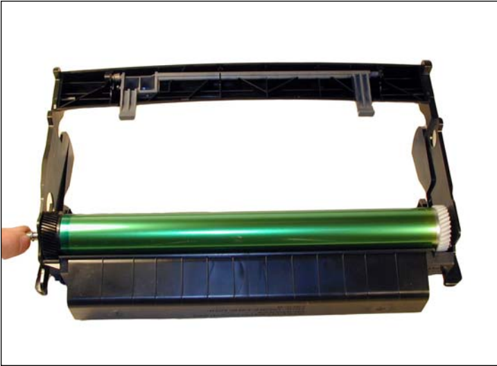
11. Insertar el eje del OPC a partir del engranaje mayor.
