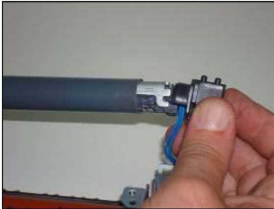
Ilustración 24. Desmontaje de la filmina. Guía lado derecho 25. Sacar suavemente la guía lado derecho. Ilustración 25
