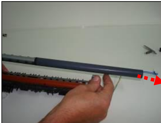
Ilustración 25. Deslizar la Filmina 26. Retirar la filmina deslizándola hacia la derecha. Ilustración 26
