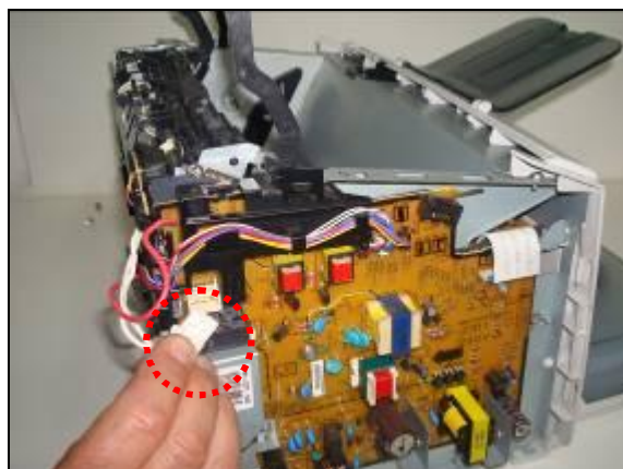
Ilustración 11. Desconexión eléctrica del fusor
