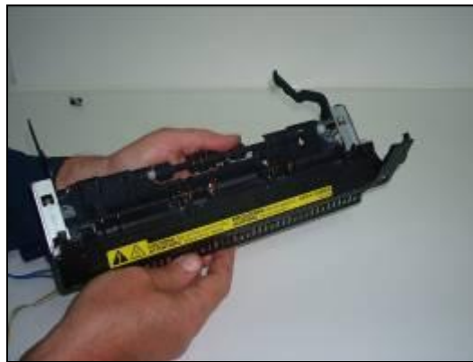
Ilustración 20. Acceso a los soportes metálicos
