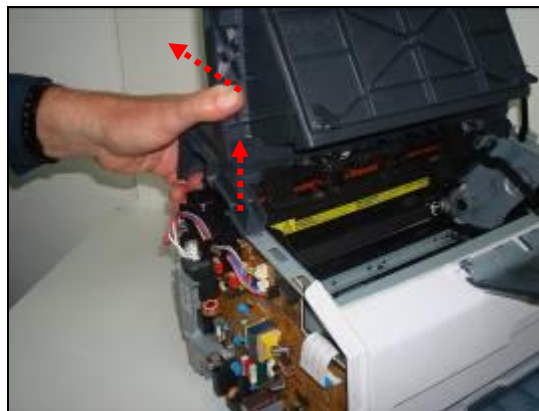
Ilustración 10. Desmontaje de la cubierta
