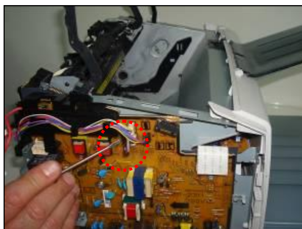
Ilustración 12. Desconexión cables de control
