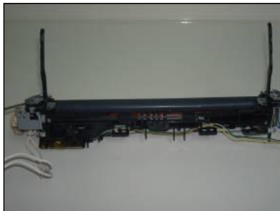
Ilustración 32. Conjunto calefactor/Filminia montados y con soportes y brazos instalados 32. Calzar el conjunto calefactor/filminia en su lugar, instalar los soportes metálicos en cada extremo, montar los resortes y los brazos. Ilustración 32
