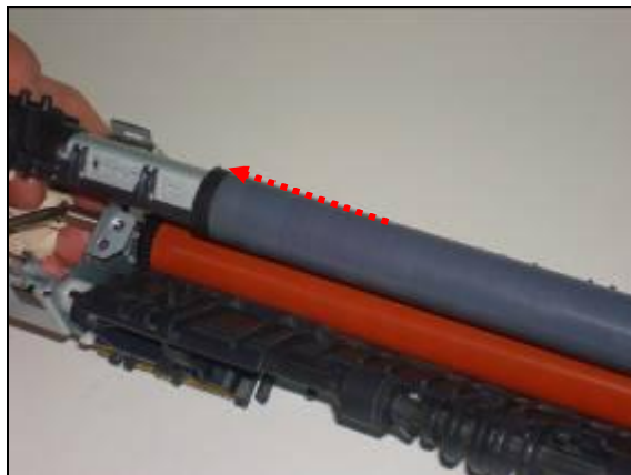
Ilustración 30. Colocación de la nueva filmina
