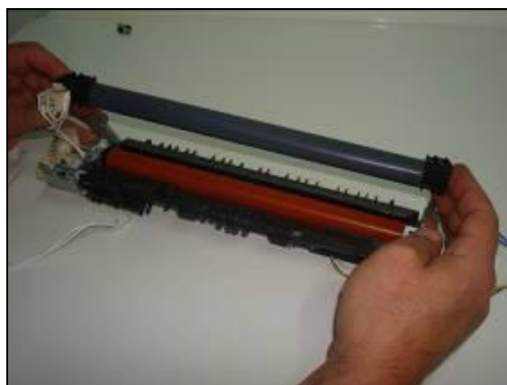
Ilustración 24. Extracción de la filmina y calefactor 24. Girar el fusor y exponer la filmina/calentador. Levantar el conjunto desde sus guías. Ilustración 24
