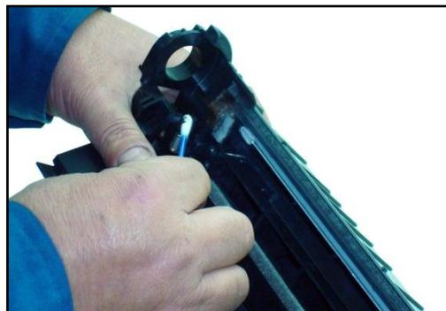
Lubricar con polvo específico, montar la cuchilla de limpieza y fijar con sus respectivos tornillos
