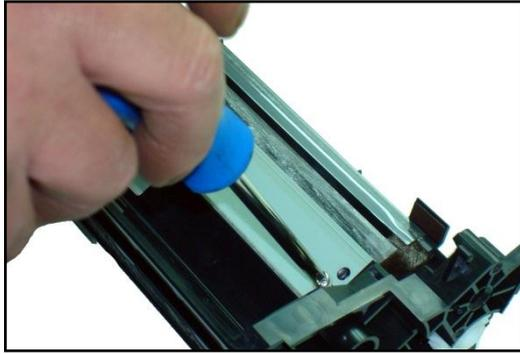
Instalar el PCR limpio y lubricar ejes con grasa conductiva
