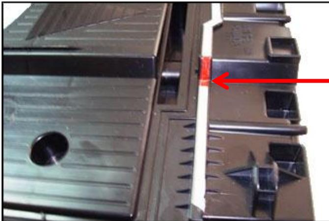
Esta línea de corte marcado en blanco posee una interrupción con rojo por donde pasa interiormente un cable-cinta flexible que debe protegerse a toda costa. No cortar donde apunta la flecha, solo marcar la superficie y el plástico será luego quebrado haciendo palanca- Recorrido total 120mm.
