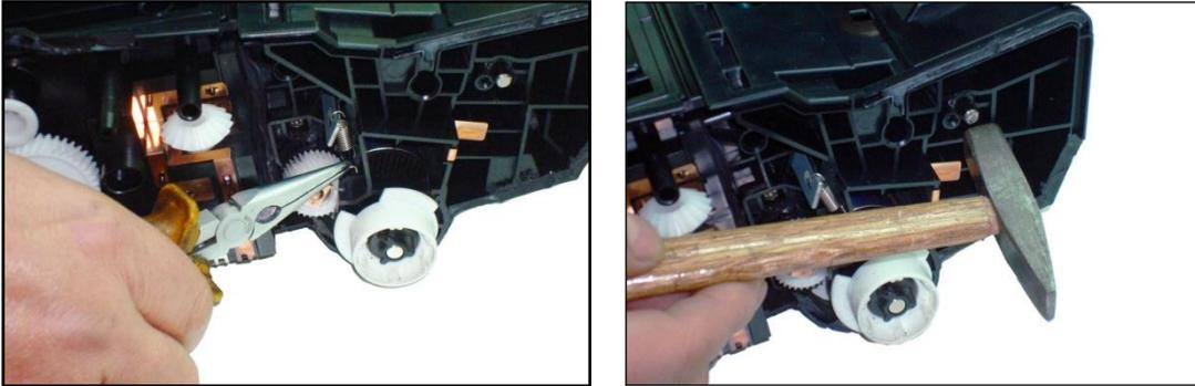
Poner el cartucho a la inversa y montar la placa rotándola hacia afuera levemente para calzar las lengüetas en cada extremo y luego presionar hacia abajo para cerrarla sobre la unidad de imagen y trabarla en su lugar.
