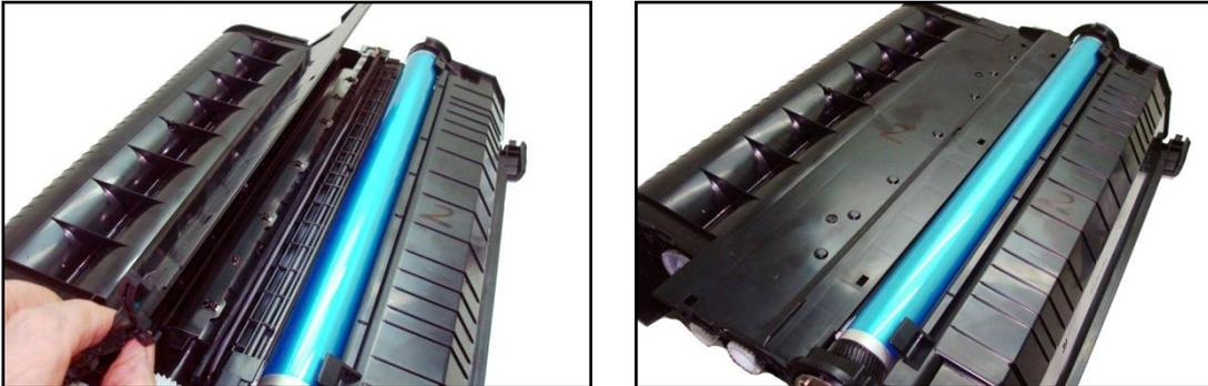
Montar el lateral derecho con sus contactos limpios haciendo que los engranajes de impulsión calcen y usando los tornillos cabeza de trompeta fijar el lateral firme contra el cuerpo del cartucho.
