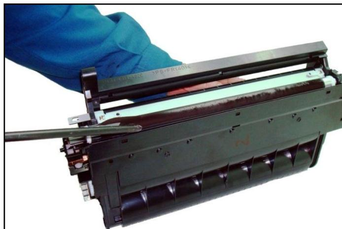
Sacar el engranaje del rodillo magnético y los dos tornillos de la placa estabilizadora,
