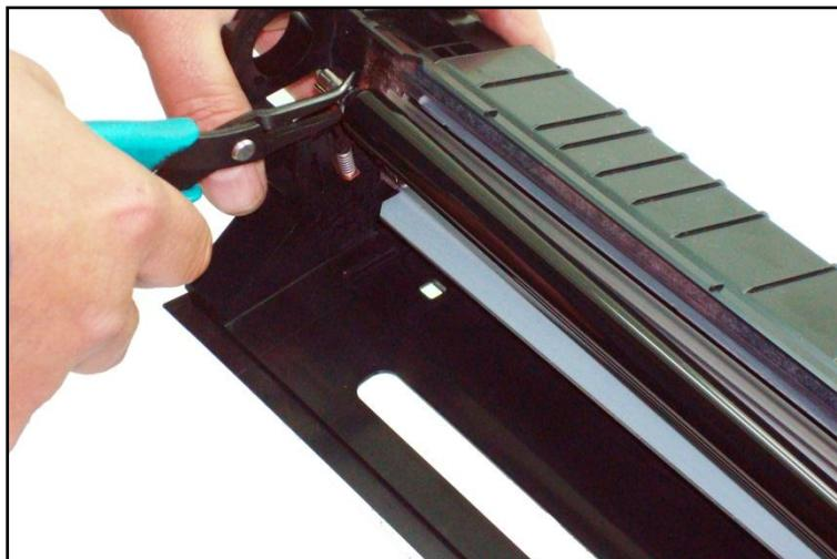
Sacar los dos tornillos que sujetan la cuchilla de limpieza
