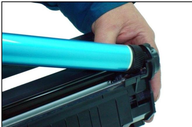
Montar la placa con el eje lubricado con grasa conductiva para el OPC y atornillar
