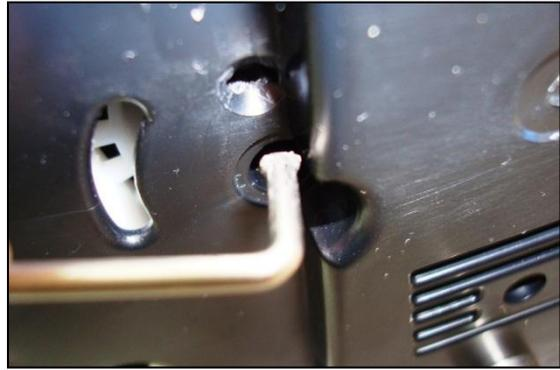
Con pinzas de punta sacar el resorte que impulsa el cierre del obturador en el lado derecho del cartucho. Mover el brazo hasta que quede horizontal y permita retirarlo de la carcasa haciendo que la parte rectangular quede libre de la lengüeta
