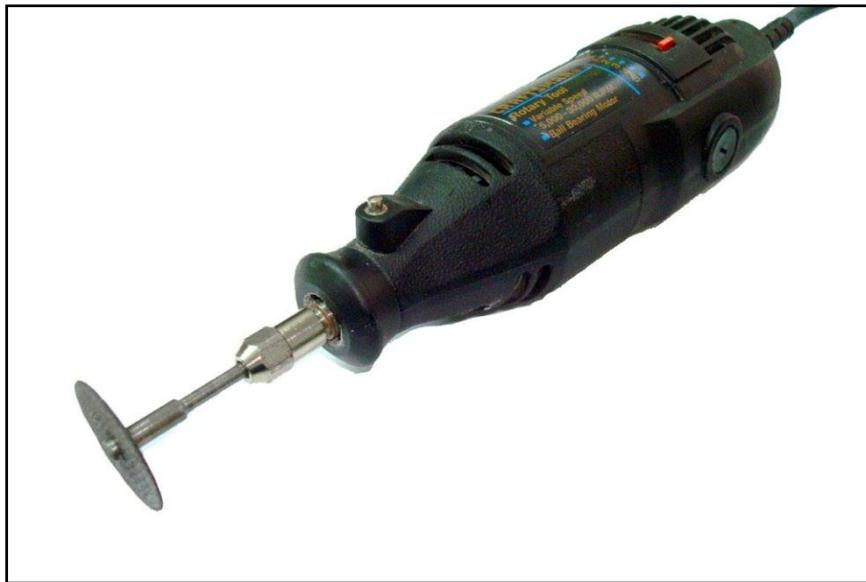
El trabajo de corte del plástico puede llevarse a cabo usando un disco de corte reforzado con fibra de vidrio tipo 426 de diámetro 23mm x 1,14 mm de espesor. La profundidad de trabajo no debe exceder los 5mm tanto en la parte superior como en la inferior excepto una sección en donde será necesario profundizar un poco más. El uso de hoja serrada y dientes finos lleva al derretimiento del plástico y a trabajos discontinuos por lo tanto no se recomienda.
