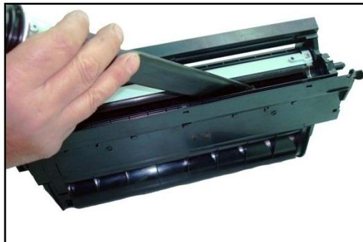
Sacar los dos tornillos de la cuchilla dosificadora y los respectivos rascadores en cada extremo.
