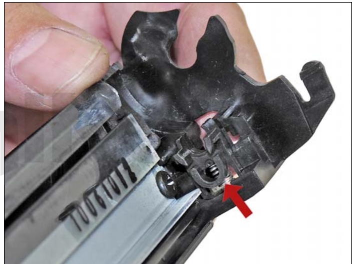
12. Sacar ambos soportes del PCR presionando sobre las lengüetas en la base. Tales soportes necesitan ser sacados para tener acceso a la cuchilla de limpieza.
