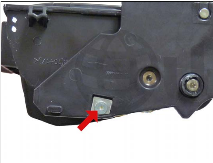
35. Instale las placas metálicas y los tornillos.
