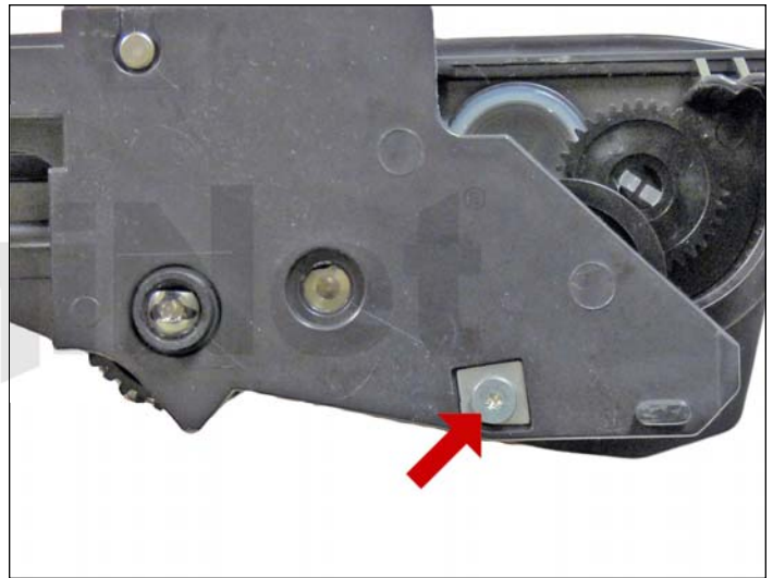
35. Instale las placas metálicas y los tornillos.
