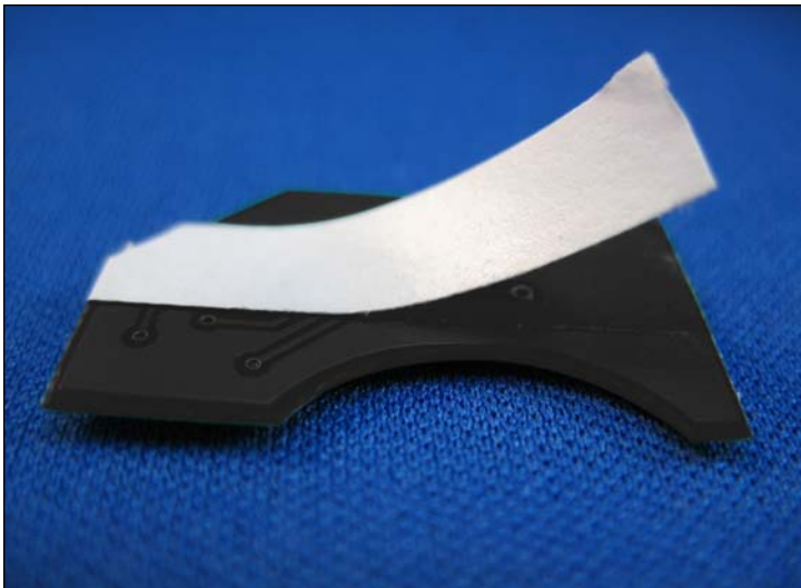
14. Retirar el papel del adhesivo del chip UniNet.
