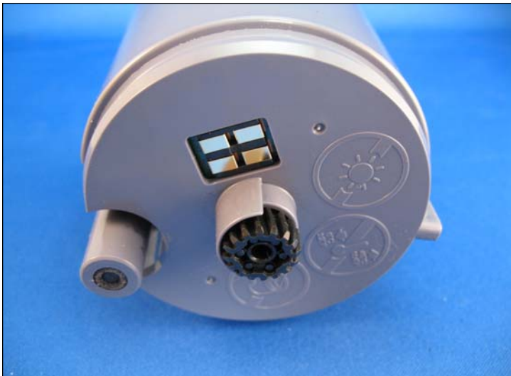
3. Fondo del cartucho mostrando su chip, engranaje del eje de agitación y boquilla de salida de toner.
