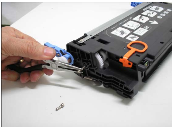
7. Repetir el procedimiento de extracción del lado opuesto. Este perno también sirve de eje para el engranaje de impulsión principal del cartucho.
