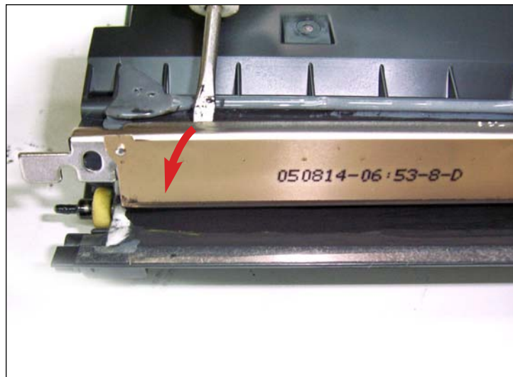
27. En el borde trasero de la cuchilla insertar un escalpelo o hoja de corte fina para separar el adhesivo sellador gris.
