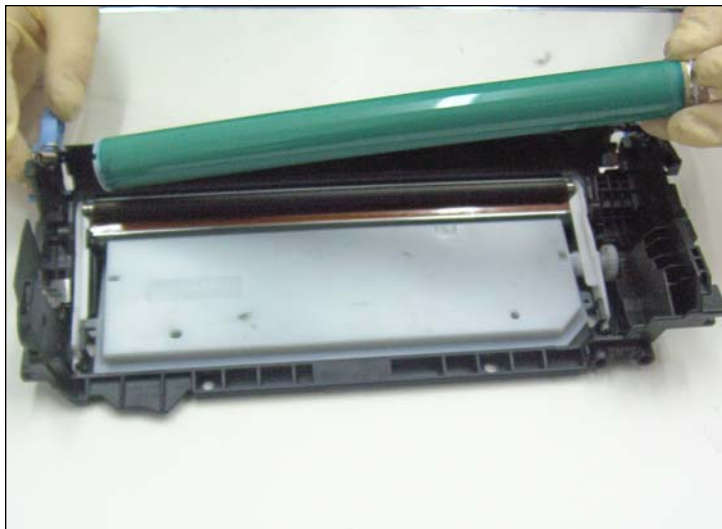
36. Sacar el cilindro como se muestra.
