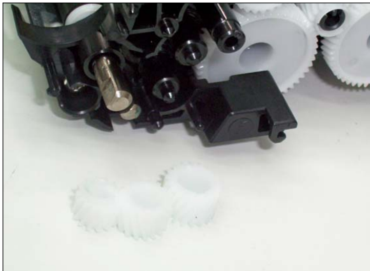
20. Los tres engranajes traseros y la placa soporte.
