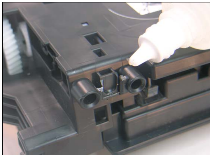
48. Puede aplicarse una mínima cantidad de adhesivo plástico en cada columna para mantener luego el chip en su lugar.
