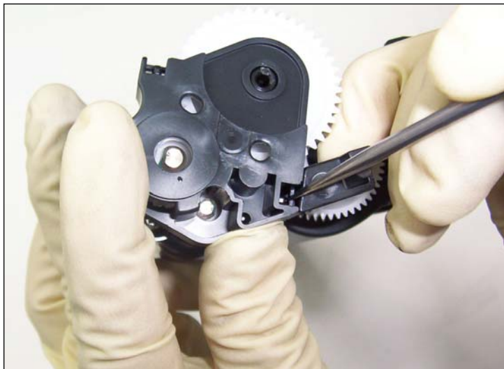
16. Ubicar la tercera lengüeta en la parte inferior de la cubierta.
