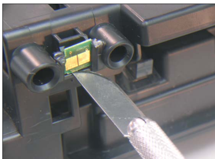
46. Con la lamina del escalpelo, suavemente levantar el chip de su base hasta sacarlo totalmente de las ranuras.
