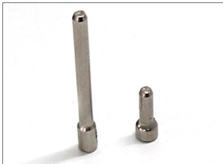
8. Notar la diferencia entre el perno del lado contactos (corto) y del lado engranajes (largo).
