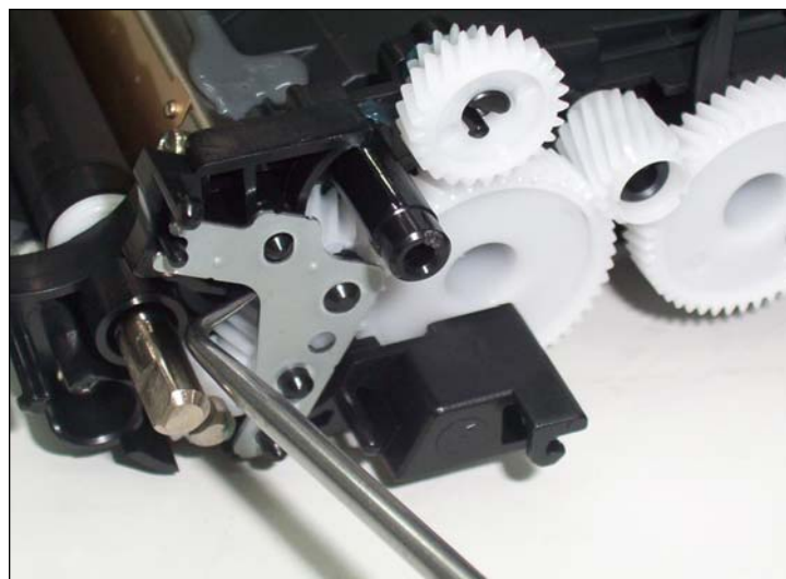
19. Con un gancho, deslizar hacia afuera la placa de retención y tener acceso a los tres engranajes restantes detrás de la placa.
