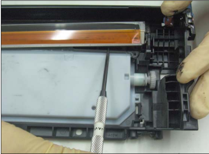
40. Calzar un destornillador fino entre la base de la cuchilla y el cuerpo para hacer palanca. Ayudar con un escalpelo el corte del adhesivo sellador color gris.
