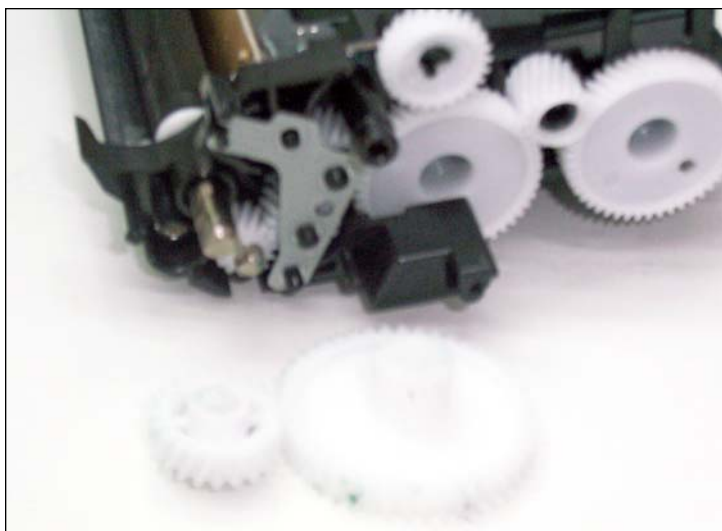
18. Sacar los engranajes del rodillo revelador como se muestra.
