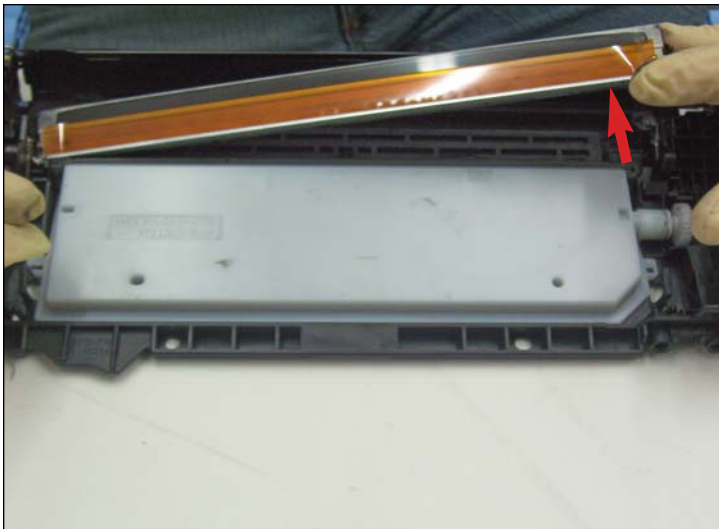
42. Suave y firmemente levantar la cuchilla hasta extraerla completamente.
