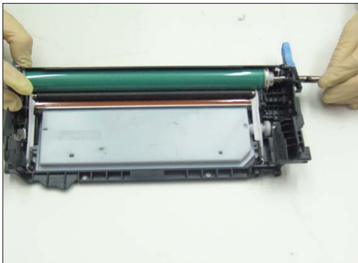
34. Vista trasera. Sacar el eje totalmente del lado opuesto sujetando el cilindro pues quedara suelto.
