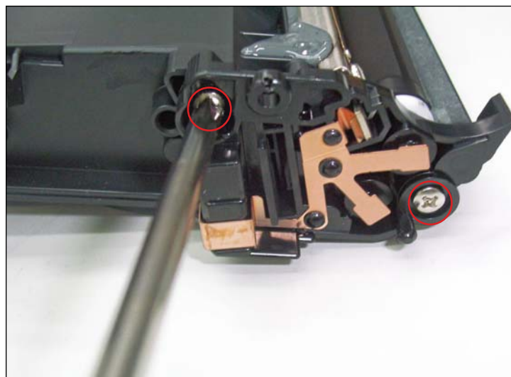
DESARMADO E LA PLACA SOPORTE, LADO SIN ENGRANAJES 23. En el lado opuesto de la tolva, sacar los dos tornillos que sujetan el soporte del rodillo revelador, tal como se muestra.
